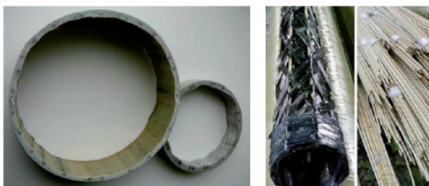
Рисунок 1 – Комбинированная стеклопластиковая опора: справа – начало намотки, слева – готовая деталь
