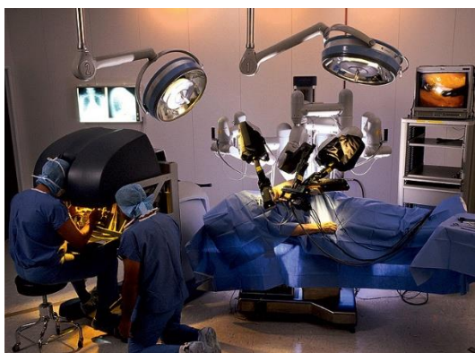
Рисунок 1 – Выполнение операции хирургом роботизированной конечностью с помощью тактильного интерфейса
